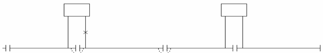
Рис.1. Восстановление электроснабжения аварийного участка путём замыкания секционора.
