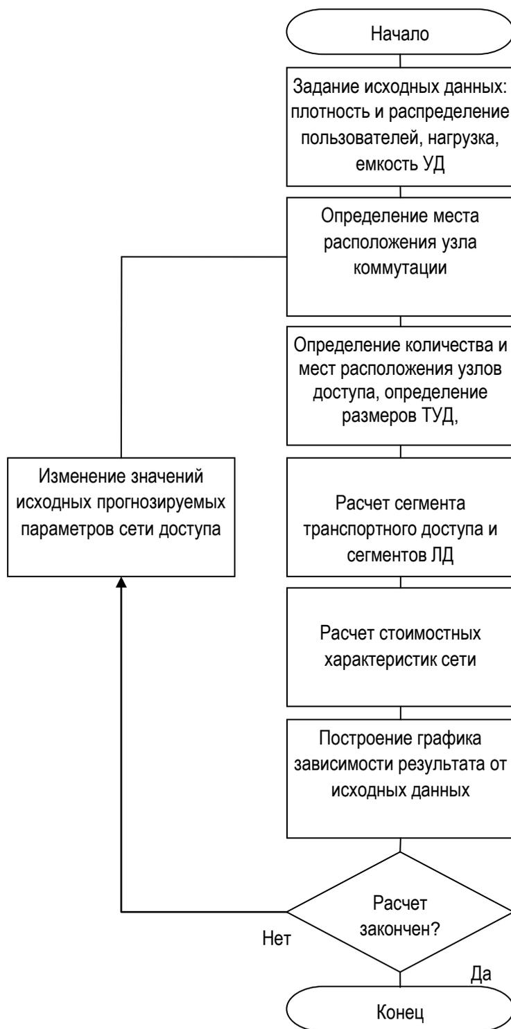
Рис. 3. Схема-алгоритм процедуры расчета характеристик СД
