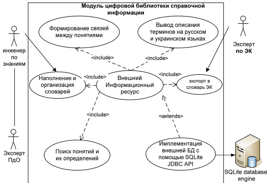
Рис. 4 Диаграмма вариантов использования модуля БСИ
