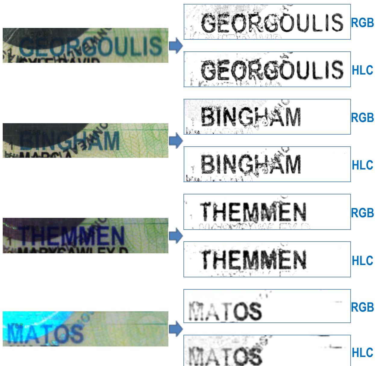
Рис 7. Результат фильтрации текстового поля водительского удостоверения штата Массачусетс (DL Mass).
