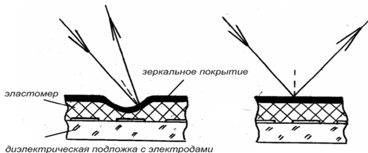
4 – Принцип работы пленочного коммутационного элемента
