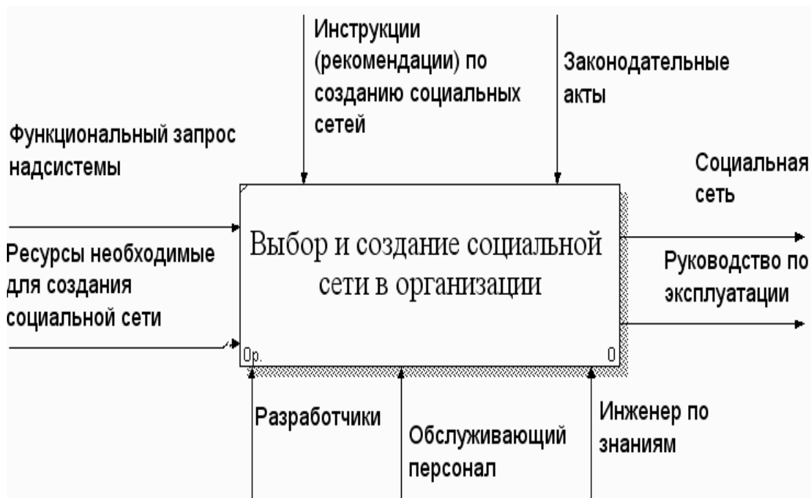
Рисунок 3 — Контекстная диаграмма информационной модели процесса выбора и создания социальной сети в организации
