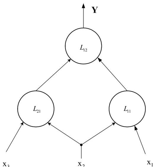
Рис. 2. Структура ТМ с сотовой структурой связи
