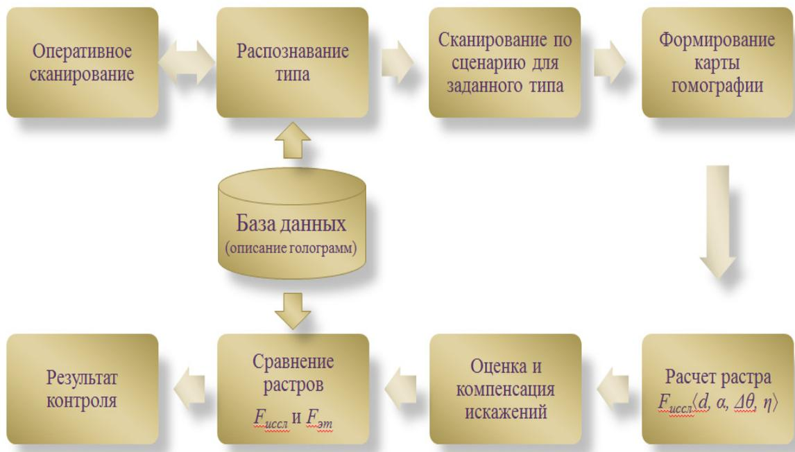
Рис 3. Схема работы прибора при проверке подлинности голограммы
