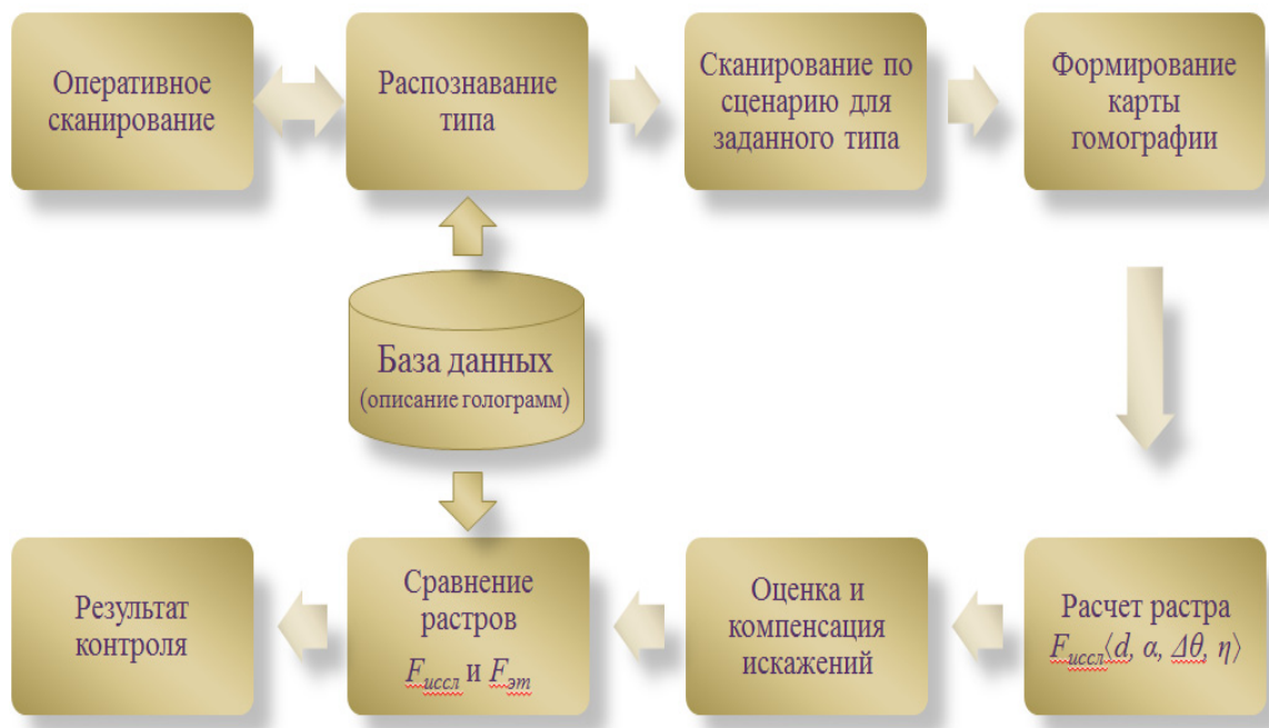
Рис 3. Схема работы прибора при проверке подлинности голограммы
