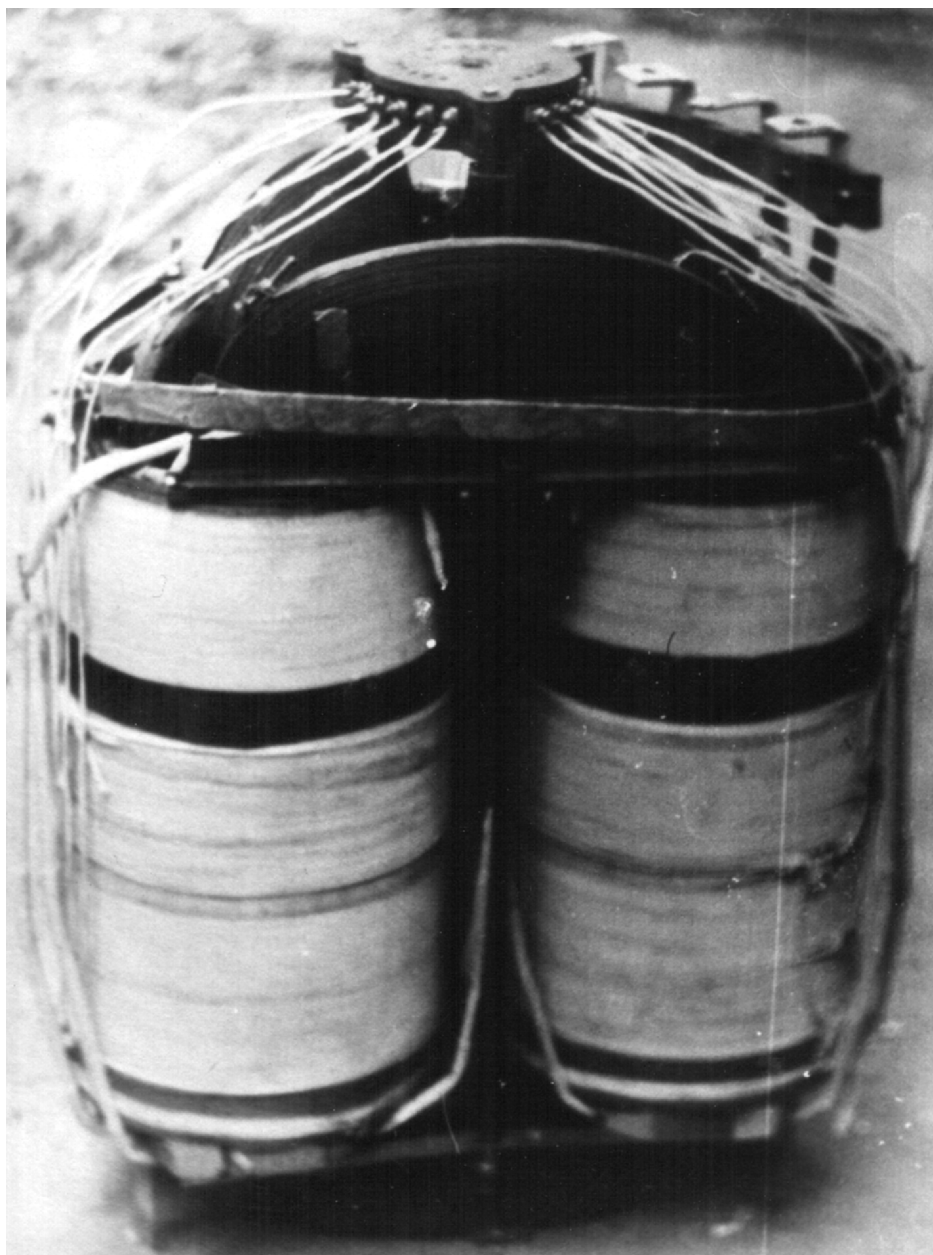
Рис. 12. Фотография активной части совмещенного управляемого реактора-трансформатора УРТ-250/10
